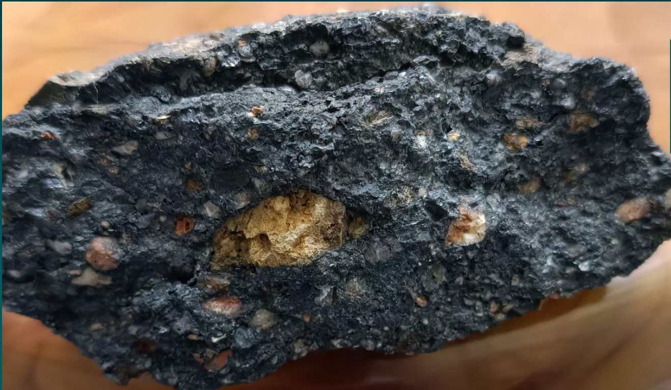
Дээж 596. Манганаар цементлэгдсэн конгломерат. Co-1500g/t, Li-1599g/t, Ni-903g/t, V-269g/t, Mn-18.69%,
