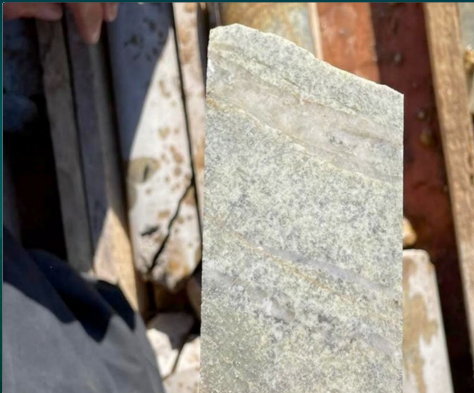
NUKTH-01-р цооног, 31.50-39.35 м, Au-0.9 гр/тн агуулгатай кварцын судланцараар хэрчигдсэн, 2-3% пиритийн эрдэсжилттэй, хүчтэй кварц-серицитжих хувиралд автсан гранодиорит
