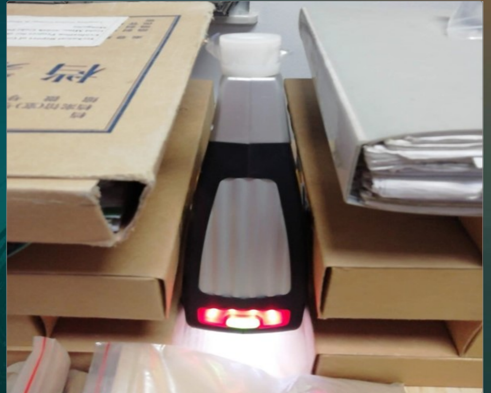
Алтан мандал хайгуулын талбайн геохимийн дээжнүүдийг Delta-XRF спектрометр
