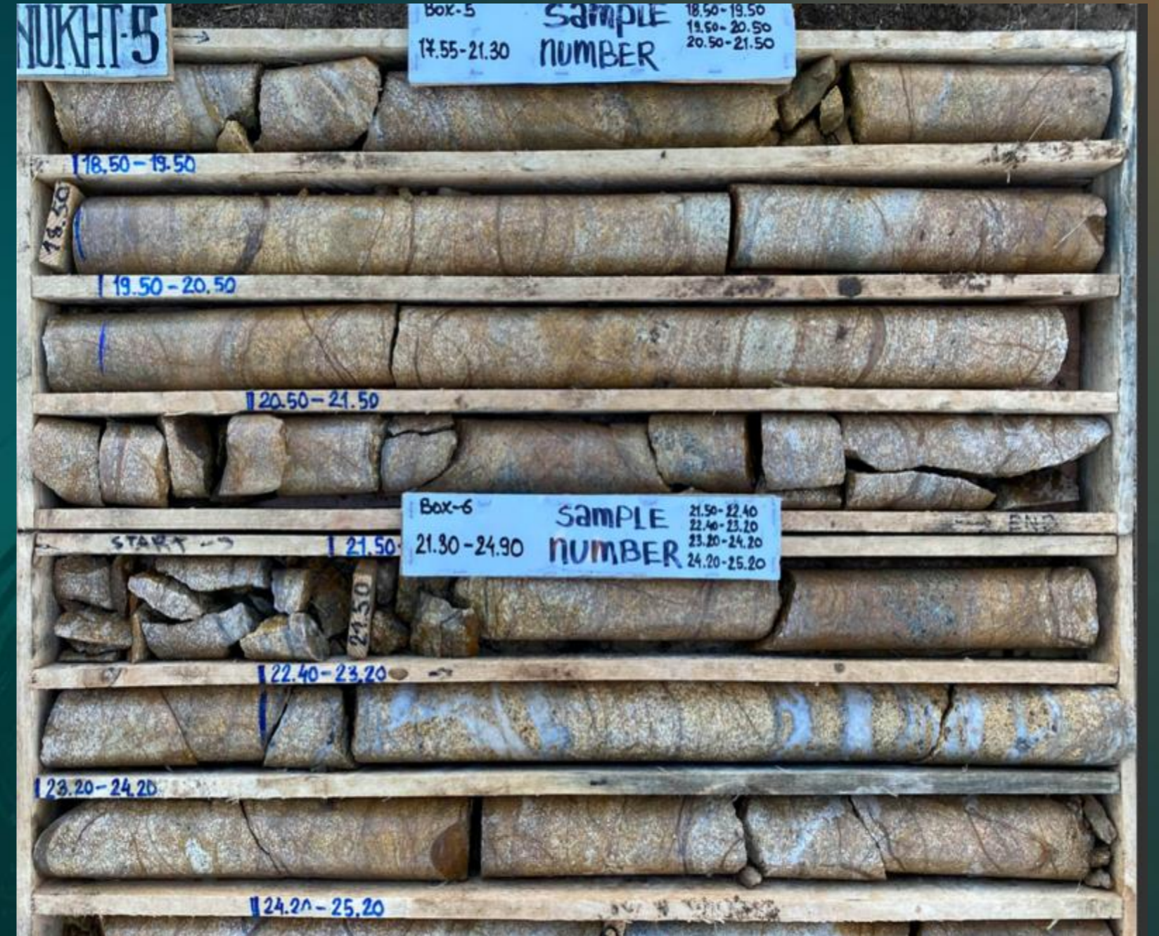
Нүхт хайгуулын талбайн Гялалзах орчмын 10 гр/тн хүртэл алтны хүдэржилттэй кварцын судал, судланцарын бүс
